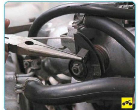
2. Снимите предохранительную скобу..
