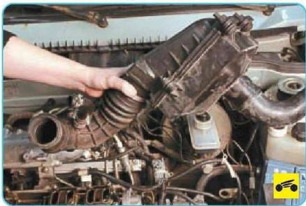
7. Отсоедините колодку жгута проводов от датчика массового расхода воздуха, ослабьте хомут крепления воздухоподводящего патрубка к дроссельному узлу и снимите с дроссельного узла патрубок с корпусом воздушного фильтра и воздухозаборным шлангом (см. «Снятие и установка воздушного фильтра», с. 145).
