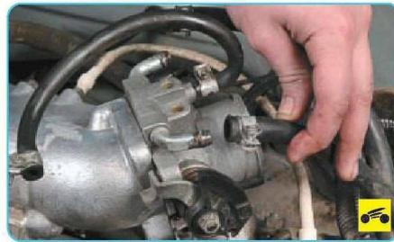
11. ...и отсоедините подводящий и отводящий шланги системы охлаждения от дроссельного узла.
