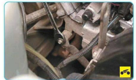
18. ...отверните гайки верхних креплений распорок впускного коллектора с правой...
