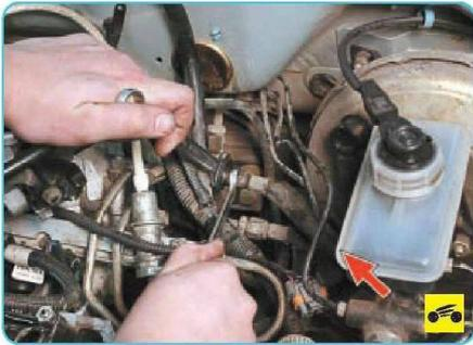
40. Отверните гайки крепления и отсоедините шланги подачи и слива топлива от топливных трубок, удерживая шланги от проворачивания вторым ключом.
