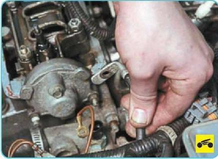
38. ...и снимите провод со шпильки крепления выпускного патрубка системы охлаждения к головке блока цилиндров.
