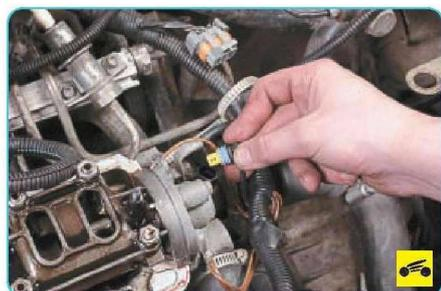
24. ...от датчика температуры охлаждающей жидкости...
