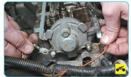
16. ...и снимите провода со шпилек.
