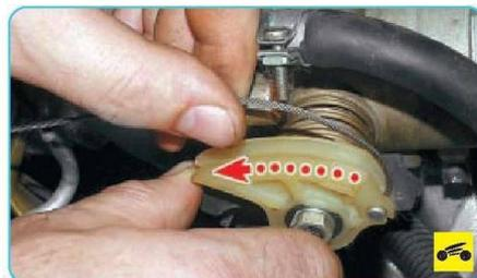
14. Поверните до упора сектор привода дроссельной заслонки и отсоедините от него тягу привода дроссельной заслонки.
