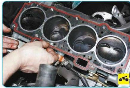
43. Снимите прокладку головки блока.
