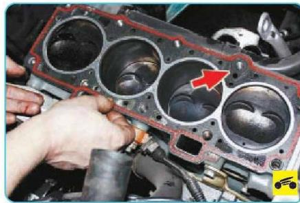
45. Установите на блок новую прокладку головки (прокладка должна быть сухой и чистой) по установочным втулкам так, чтобы отверстия для прохода масла в прокладке (с мед-
